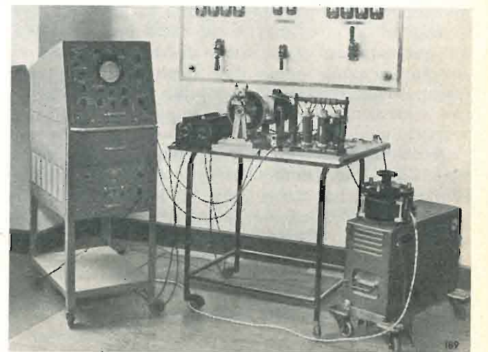
Insieme dell'apparecchiatura con alimentatore (a destra) e oscillografo (sincronizzato a monte della linea di ritardo in modo che il fascetto elettronico si sganci circa 0,5 microsecondi prima dell'arrivo dell'impulso).
