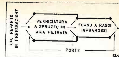
Fig. 5 - Schema in pianta del forno preceduto dal capannone di verniciatura; questa precede immediatamente l'essiccazione ed ambedue le operazioni avvengono in ambiente di aria filtrata.
